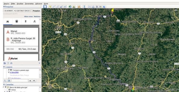
Distância da Usina de asfalto de Muriói: 95,70km DMT 151,00+95,70 / 2 = 123,35km
