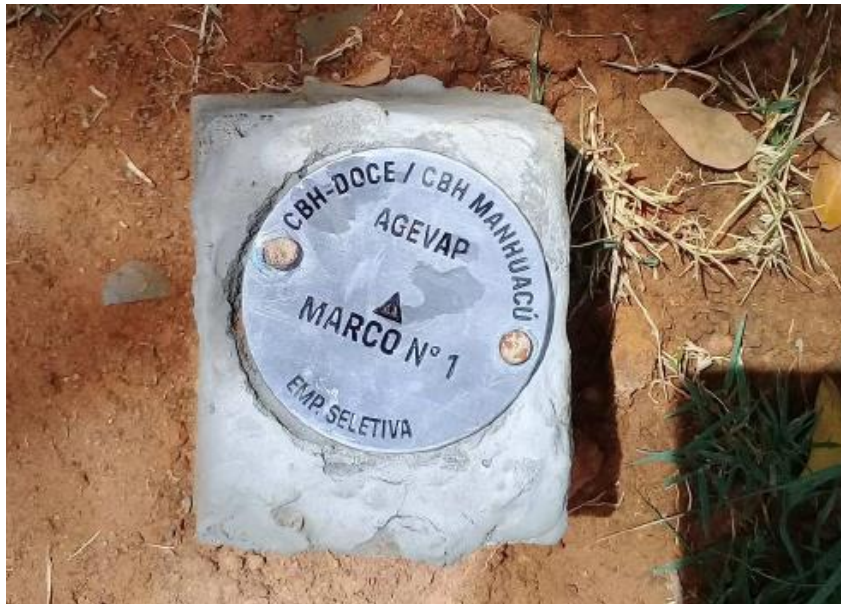
Figura 8 – Exemplo de marco topográfico
